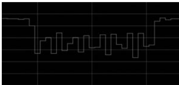
b) – телевизионная камера с несимметричным корректором четкости WAT-902H
